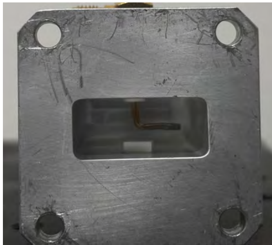
Figura 4.4: Antena diseñada para excitar el modo TE_{01} montada en acoplador estándar
