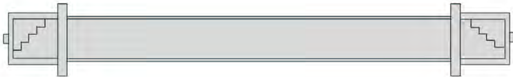
Figura 4.7: Guía de Onda vacía con Acopladores TM de 16GHz en Adelante (Antenas TM_{11} )
