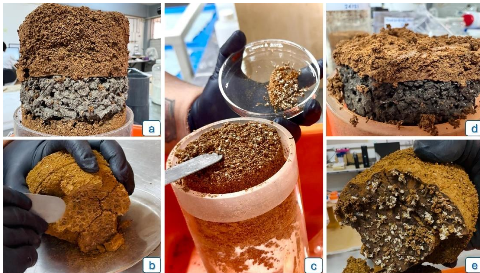
Figura 13. Proceso de desmontaje de columnas y separación de componentes
