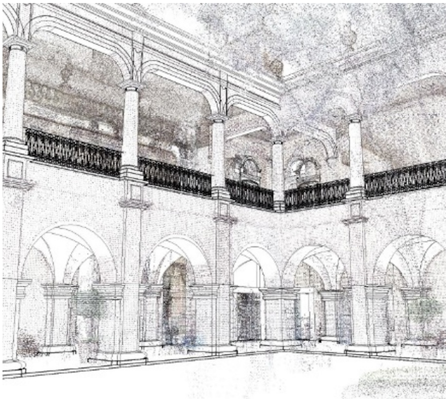
Figura 4. Sobreposición de geometrías y nube de puntos del Edificio Central UASLP.
