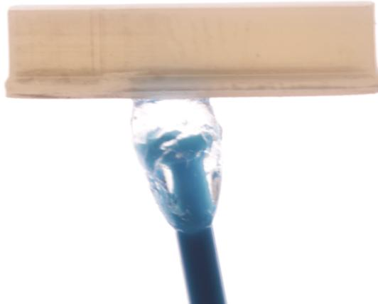
**Imagen 8.** Barra impresa en resina 3D con resina Jamg He, una vez realizado el post procesado
