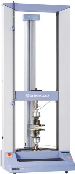
**Imagen 17.** Máquina de ensayos universales Shimadzu
