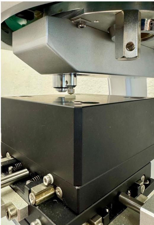
**Imagen 20.** Prueba de dureza de Vickers sobre cilindros de resina
