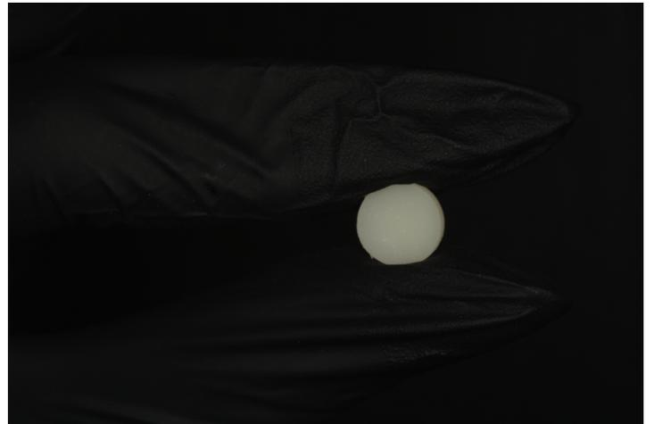
**Imagen 16.** Disco de resina 3d y OG, impresos, utilizados para las pruebas mecánicas
