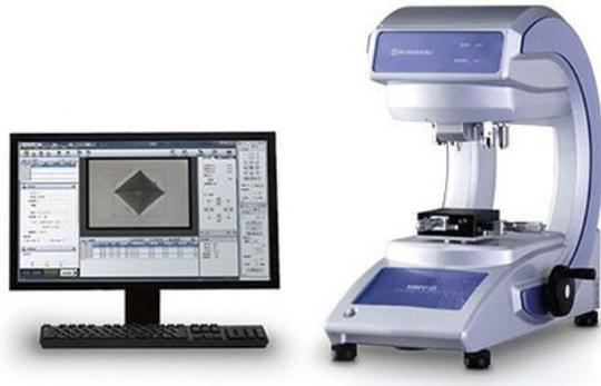
**Imagen 15.** Shimadzu HMV-G, utilizada para realizar prueba mecánica de Vickers
