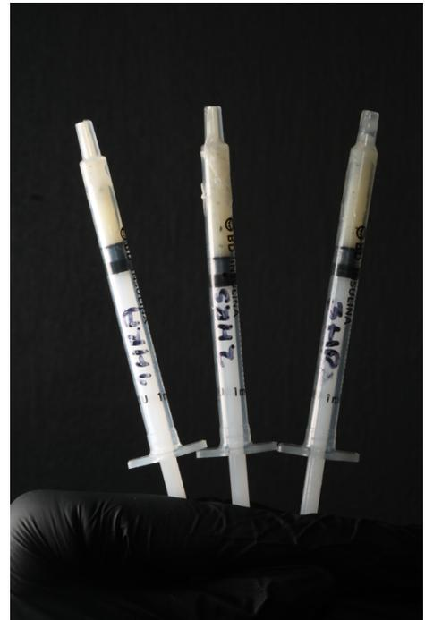
**Imagen 12.** Jeringas con resina 3D adicionada con OG, utilizada para dispersión en diferentes tiempos.
