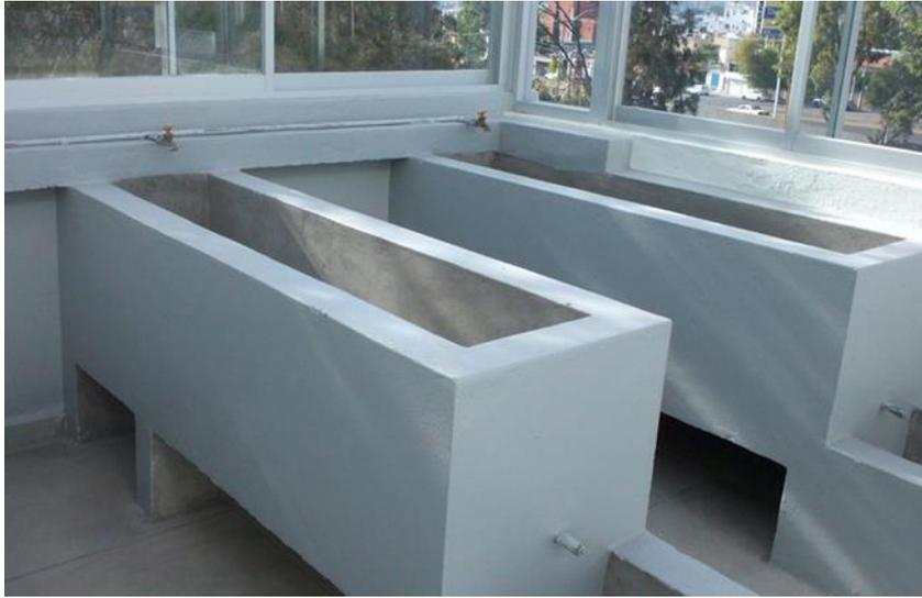
**Figura 8.** Celdas de humedal de tipo subsuperficial a microescala (Zapata, 2018)
