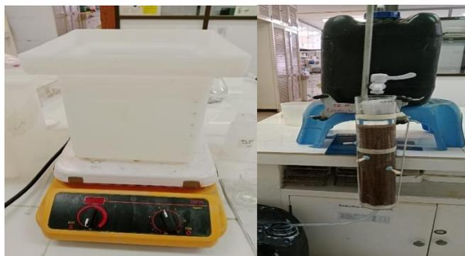
**Figura 9.** Aplicación del proceso de tratamiento del agua de rechazo sintética por coagulación y floculación seguido de filtración en columna empacada con arena.
