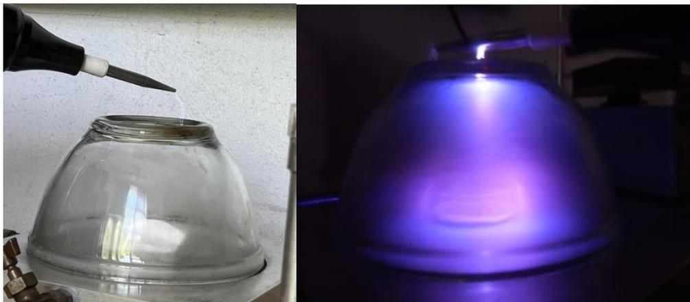
**Fig. 6** Descarga de luz Tesla sobre rejillas de TEM para hidrofiliarlas [27]
