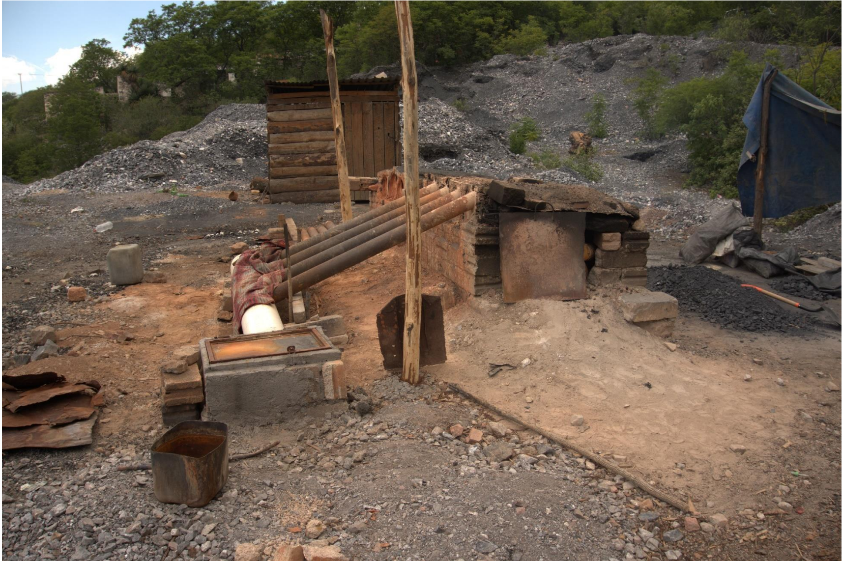
Fig. 3 Horno artesanal para la producción de mercurio Camargo, Peñamiller, Querétaro (Fuente: elaboración propia)
