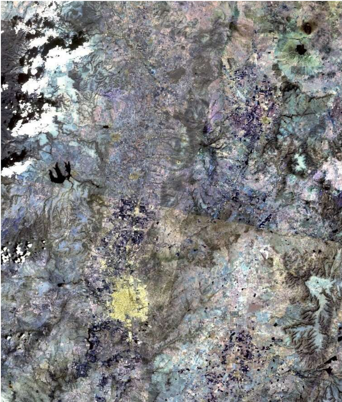
Figura 16: Imagen ASTER en combinación de bandas RGB 864 en el subsistema SWIR.
