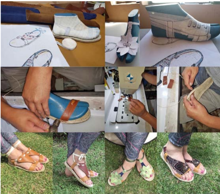
Figura 7. Banderas, P.Guzmán]. (2020). Sandalia con empeines intercambiables, el proceso de ideación, bocetaje, modelado, prototipado y validación se realizó con medios virtuales y colaboración de todos los actores.
