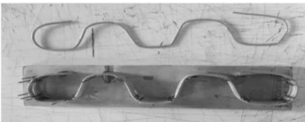
Ilustración 6. Máquina de doblado de varilla de mimbre; tabla con clavos.
