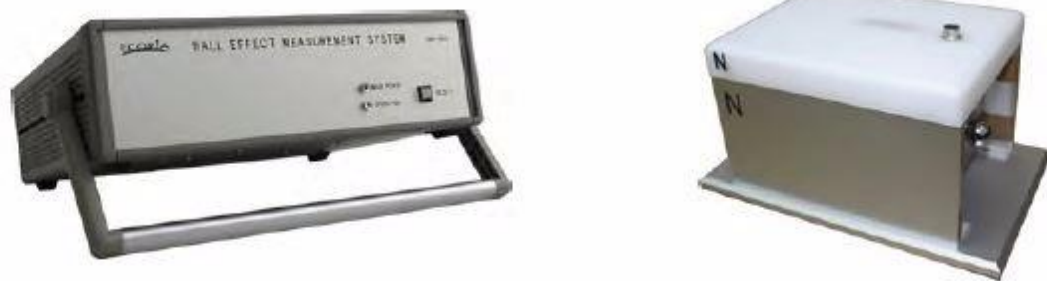
Figura 19. Sistema para medición de efecto Hall ecopia.
