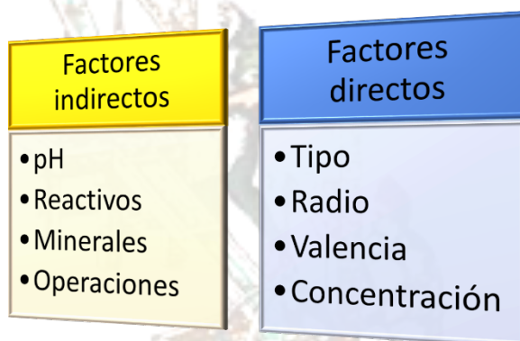
Figura 3: Factores que influyen en la función de los iones metálicos en la flotación.
