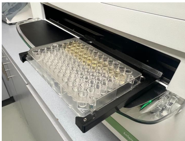
Figura 6. Lectura de absorbancia del modelo de difusión para determinar la inhibición del crecimiento bacteriano de E. faecalis en presencia de \text{Ca}(\text{OH})_2 , AgNP y \text{ZnO}_2\text{NP} .
