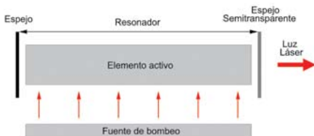
Fig. 1.2 Diagrama simplificado de un sistema de luz láser, también llamado resonador óptico.
