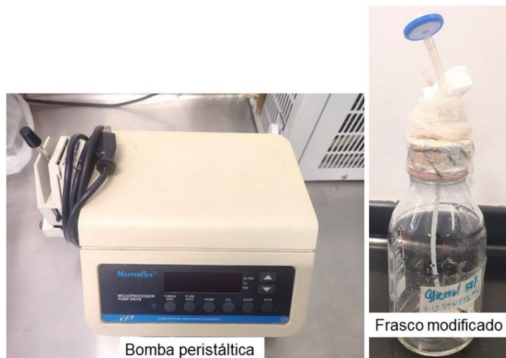
Figura 4. Bomba peristáltica añadida y ejemplo de frasco modificado para la adición de preinóculo, medio de cultivo y sustrato en la operación Fed-Batch.
