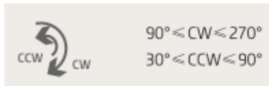
Figura 14. Esquema de movimiento recíproco del sistema Endostar E3 Azure
