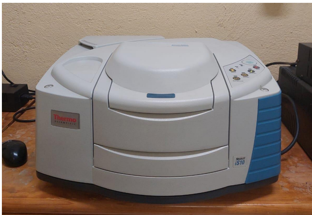
Figura 5.5 Espectrofotómetro con transformada de Fourier marca Thermo Scientific modelo Nicolet iS10 FT-IR
