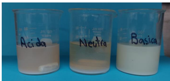
Figura 6.30 Prueba de jarras realizada con una carga de floculante de 0.4 mL L -1 , variando el pH a 2.5, 7.5 y 9.0 respectivamente.
