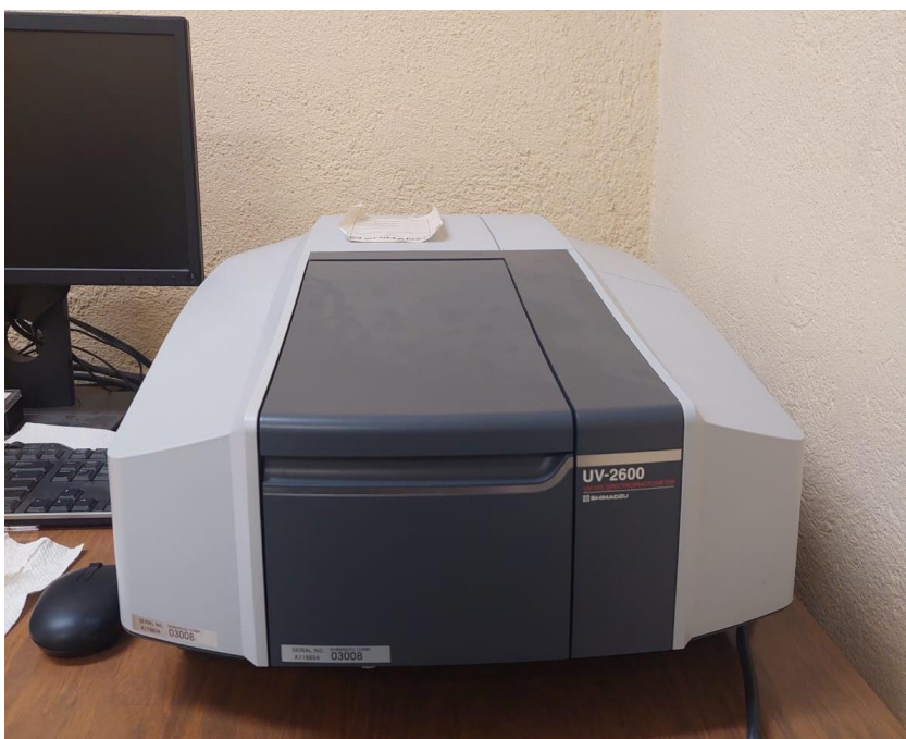
Figura 5.3 Espectrofotómetro de Ultravioleta-visible (UV-vis) Shimadzu UV-2600
