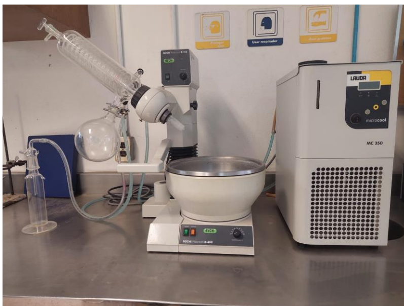
Figura 5.6 Rotavapor marca BÜCHI modelo R-114, con microcool marca LAUDA MC-350
