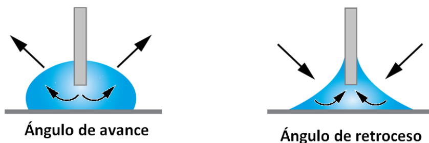
FIGURA 2.3: Ángulos de avance (izq.) y retroceso (der.) medidos mediante el método de aguja.
