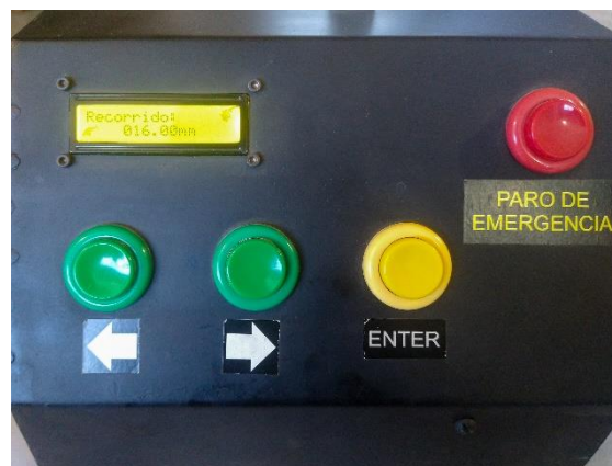
Figura 11. Caja de control con pantalla LED para observar los datos. (Botón rojo: paro de emergencia, botones verdes: navegar en el menú, botón amarillo: enter)
