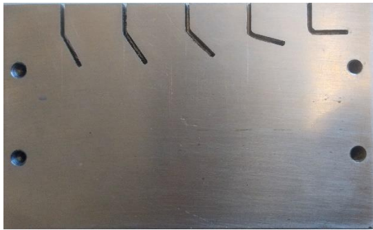
Figura 12. Platina de acero inoxidable con angulaciones de 25°, 45°, 60°, 75° y 90°
