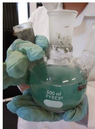
Figura 4b.- Solución lixiviada para un tamaño de muestra de 0.250 mm.
