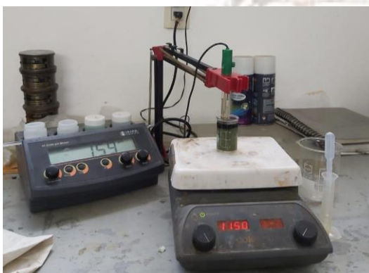
Figura 5.- Sistema de extracción para la variación de pH.
