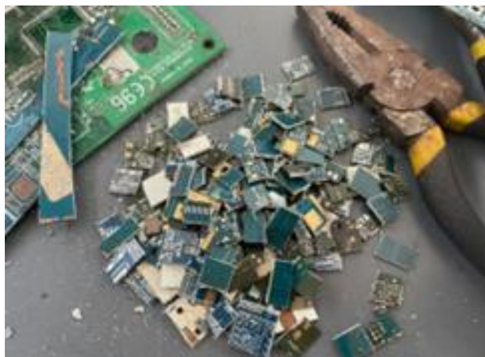
Figura 1.- Preparación de las tarjetas de circuitos impresos para su molienda.
