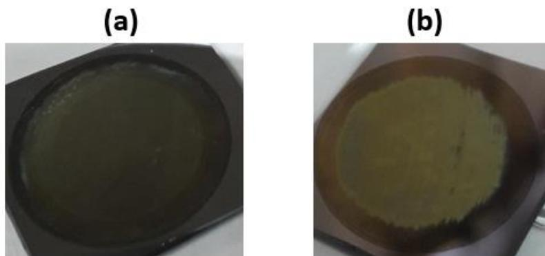
*Figura 3.21. a) Monocapa de 20 mA fabricada durante la calibración. b) Monocapa de 20 mA fabricada una semana después de la calibración.*
