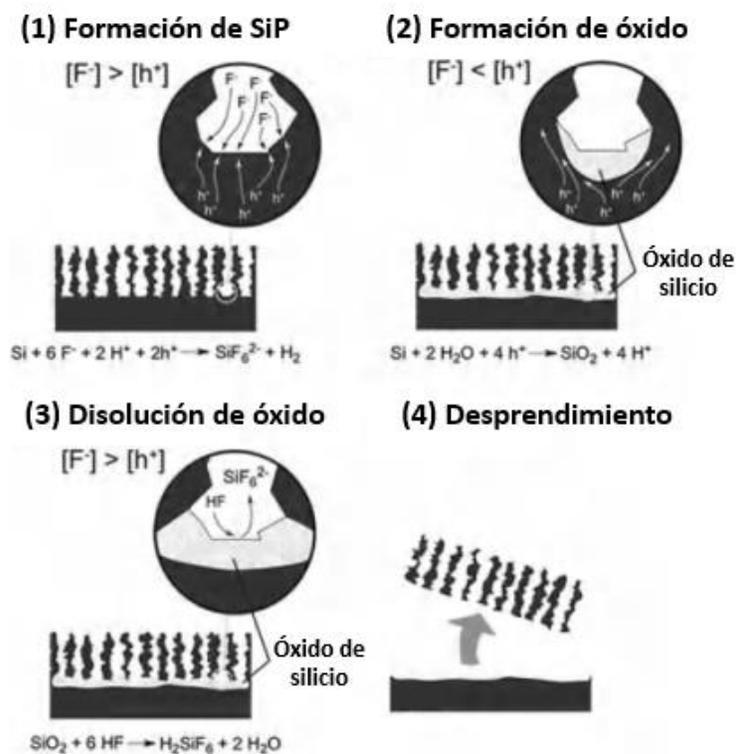
Figura 2.9. Procedimiento para desprender películas de silicio poroso de su sustrato cristalino mediante electropulido. Se muestran también las reacciones químicas relevantes en cada paso. Figura adaptada de la Referencia 29.
