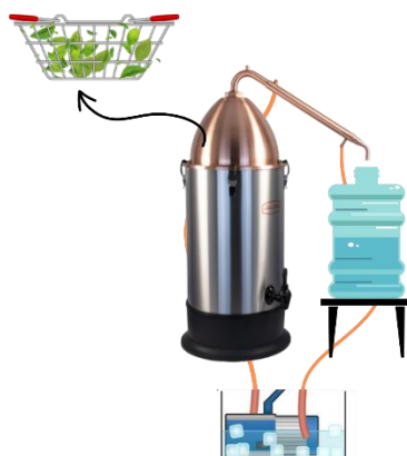
Figura 14. Sistema para destilación por método de arrastre de vapor asistido por destilador
