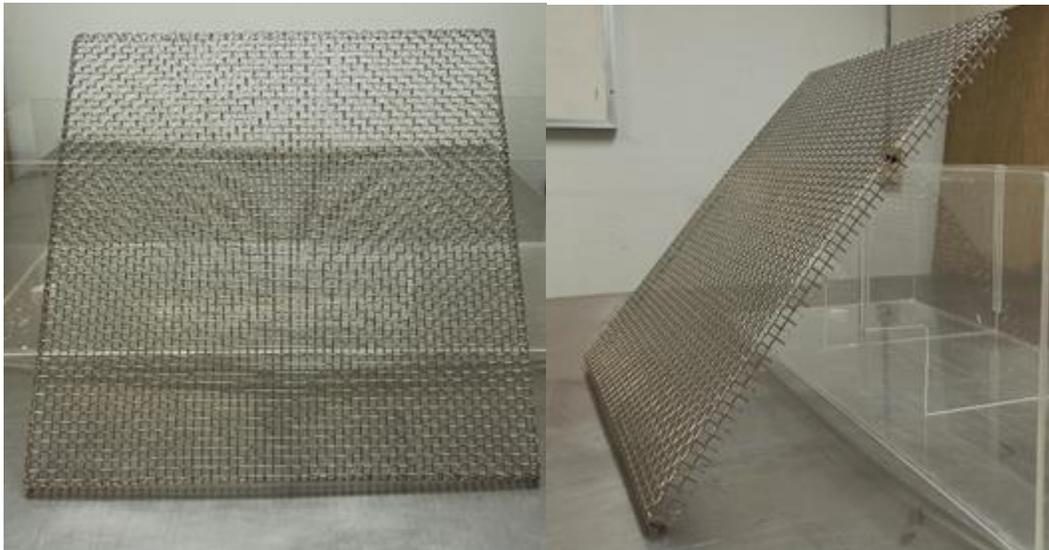
*Figura 10. Estructura para la prueba de negative geotaxis. La malla tiene una inclinación de 45° sobre la horizontal.*
