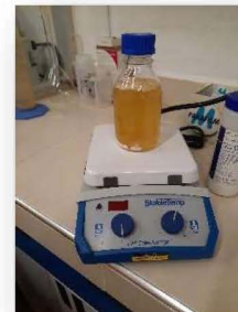
Fig 6. Se mezclan los 250ml de agua destilada con 9.25gr de BHI en polvo
