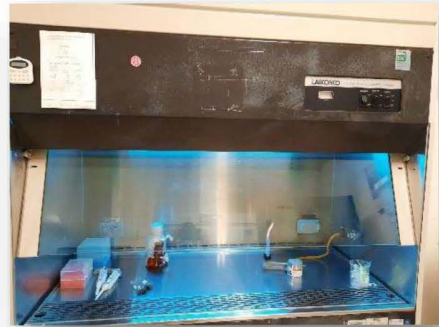
Fig 8. Se limpia la campana con alcohol y se desinfecta con luz ultravioleta 15min
