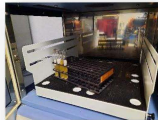
Fig 12. Se dejan incubar los tubos 24hrs a 37°C
