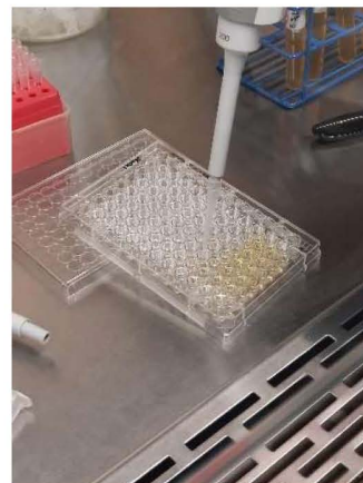
Fig 18. Se pasan 75 \mu l de mezcla al sig pocillo para ir diluyendo la concentración
