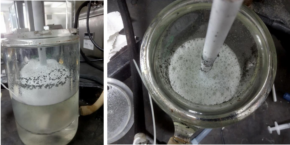
Figura 44.- Espuma producida el sistema de lixiviación con T80-1000
