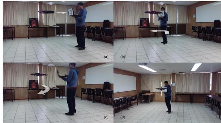
Fig. 12. Control servo visual mediante seguimiento de objetivos (Tracking), modos de vuelo (a) alineación de UAV AR.Drone con objetivo (centro del círculo), (b-c) control de navegación Yaw y (c) control de navegación vertical.
