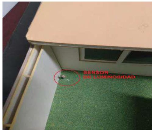
Figura 14. Ubicación del sensor de luminosidad.
