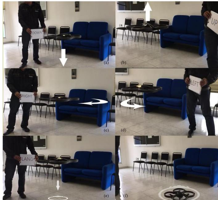
Fig. 11. Control servo visual mediante el reconocimiento óptico de caracteres, etiquetas con comandos de control de navegación propuestos. (a) Down, (b) Up, (c) Right, (d) Left, (e) Land y (f) Modo Land.
