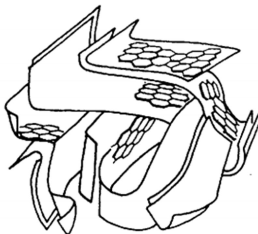
Figura 2.2. Representación esquemática de la estructura de un carbón activado.
