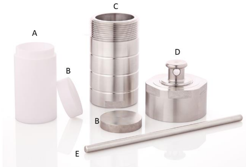
Figura 4.2 Reactor autoclave para proceso de carbonización hidrotermal A: Cámara de recipiente de teflón, B: Tapa de la cámara de teflón superior e inferior, C: Recipiente de acero inoxidable, D: Tapa de la cámara de acero inoxidable (aleación SS 304), E: Barra de acero inoxidable para cerrar el reactor.
