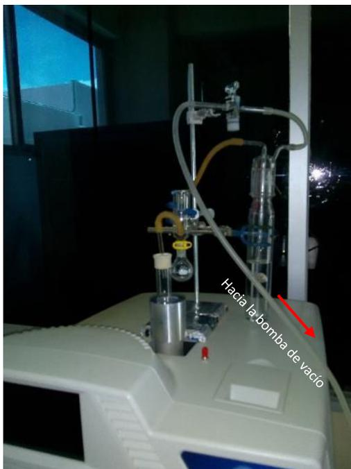
*Fotografía 3: Exterior de reactor de marcaje*
