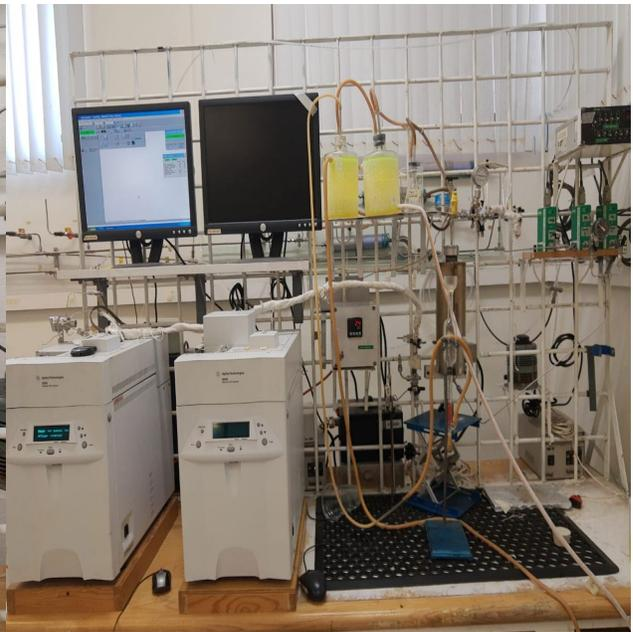
Figura 8-5. Sistema de pirólisis en operación
