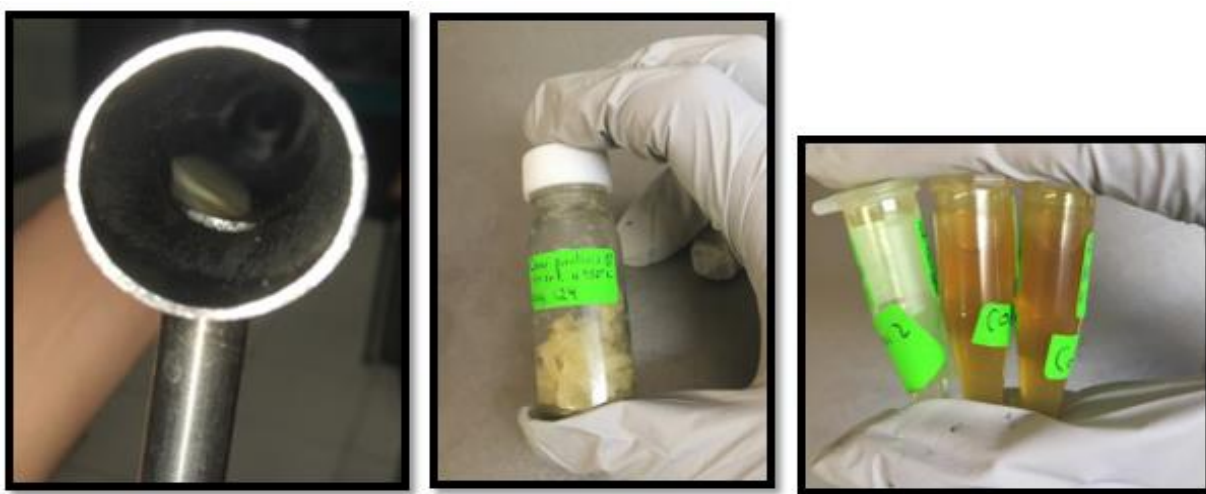
Figura 6.1 A) Ceras sobre el tubo reactor producto de la pirólisis térmica de PP B) Ceras recolectadas de la pirólisis térmica de PP C) Muestra de aceites condensables en pirólisis catalítica de PP.
