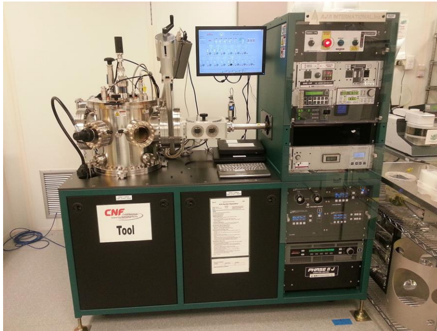
Figura 3.29. Sistema Sputtering para depósito de películas.
