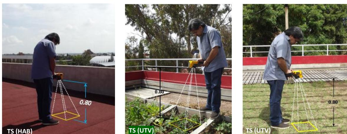
Figura 5. Medición de la temperatura superficial (TS) en los dos sitios de estudio, por medio de un procesador de imágenes termográficas. En el cuadro de color amarillo se indican las tomas de las imágenes termográficas en el HAB, en el UTV (en hortalizas) y UTV.
