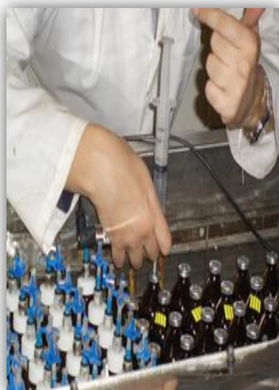
Figura 5. Medición de presiones producidas.
