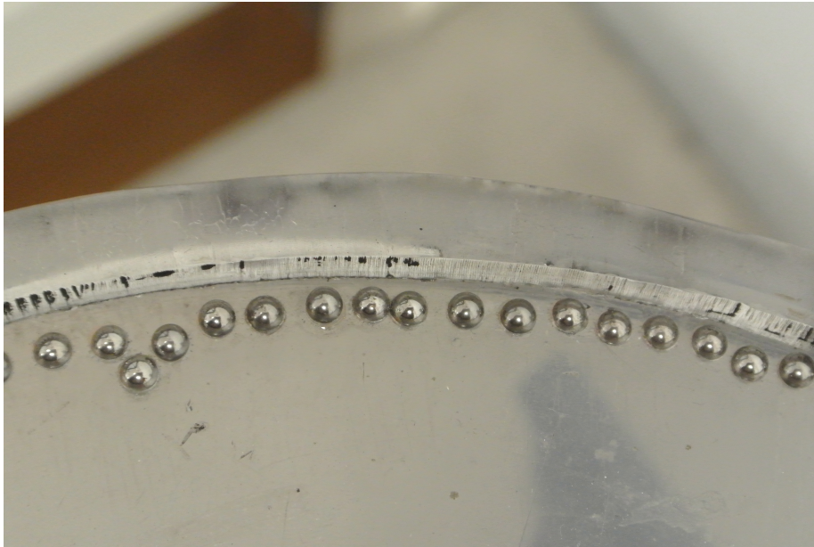
Figura 2.2: Esferas incrustadas cerca de la orilla del sistema (en este caso con la celda vacía), para evitar efectos de borde.
