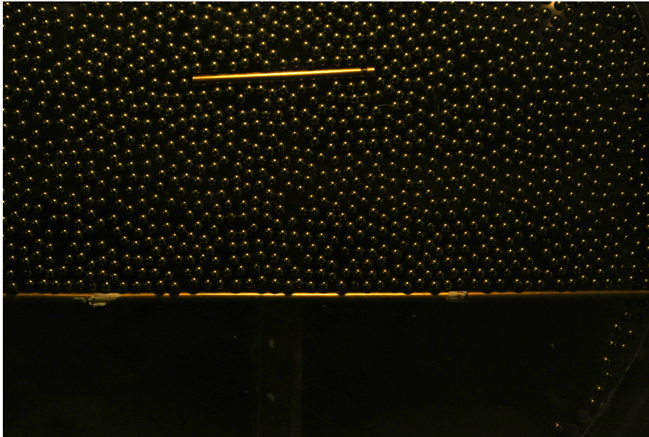
Figura 2.5: Configuración experimental para obtener el potencial efectivo entre dos rodillos, uno fijo y otro móvil.
