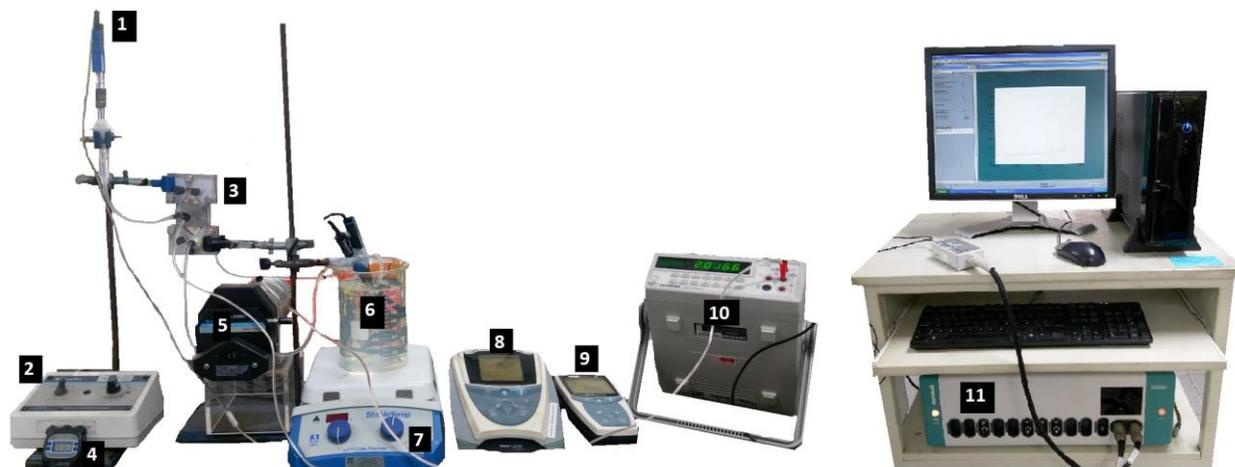
**Figura 16. Sistema de oxidación electroquímica. 1) Electrodo de referencia; 2) Regulador de velocidad; 3) Mini-reactor electroquímico 4) Cronómetro; 5) Bomba peristáltica; 6) Reservorio; 7) Parrilla de agitación magnética; 8) Potenciómetro ; 9) Conductímetro; 10) Multímetro digital; 11) Potenciostato/galvanostato.**
