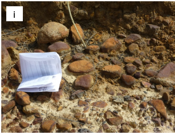
Figura 5.11 (Continuación) Fotografías descriptivas del Arroyo Principal: g) Sedimentos con características de jales depositados antes del borde del arroyo; h) Sedimentos muy finos y sueltos del arroyo a la altura del borde; i) Piedras con precipitados de óxidos encontrados en la zona de baja energía del cauce del arroyo (posterior al borde); j) Cauce en la zona de baja energía donde las paredes del arroyo muestran precipitados de óxidos y se observa entrada de vehículos ya que los lugareños toman el sedimento fino para usarlo como material de construcción.
