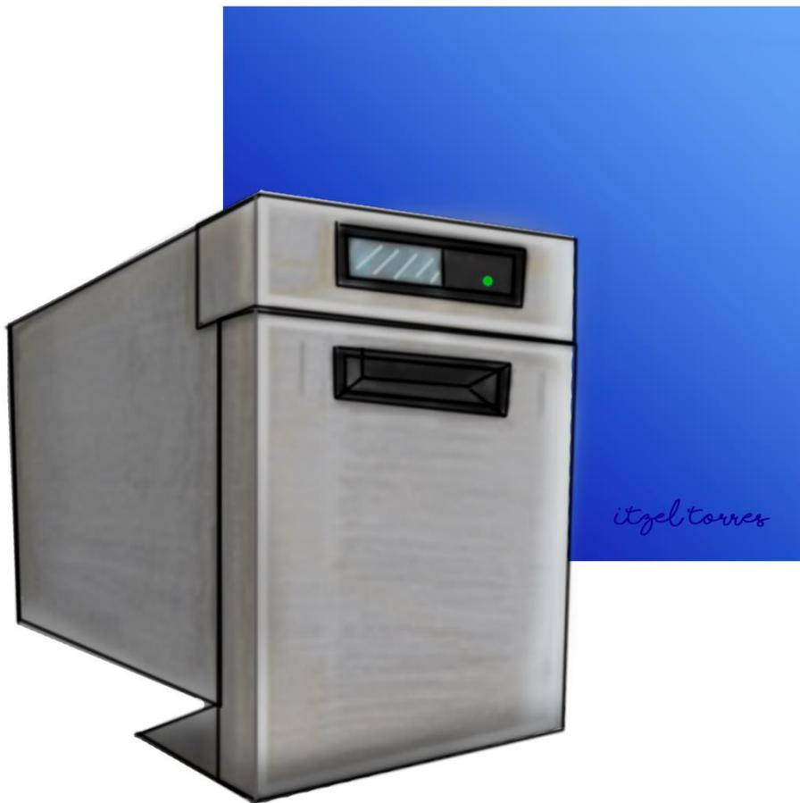
El anterior boceto, presenta una alternativa de solución de un gabinete con sensor en la parte superior media, para accionar el mecanismo. Tiene una puerta de menor tamaño, de apertura
