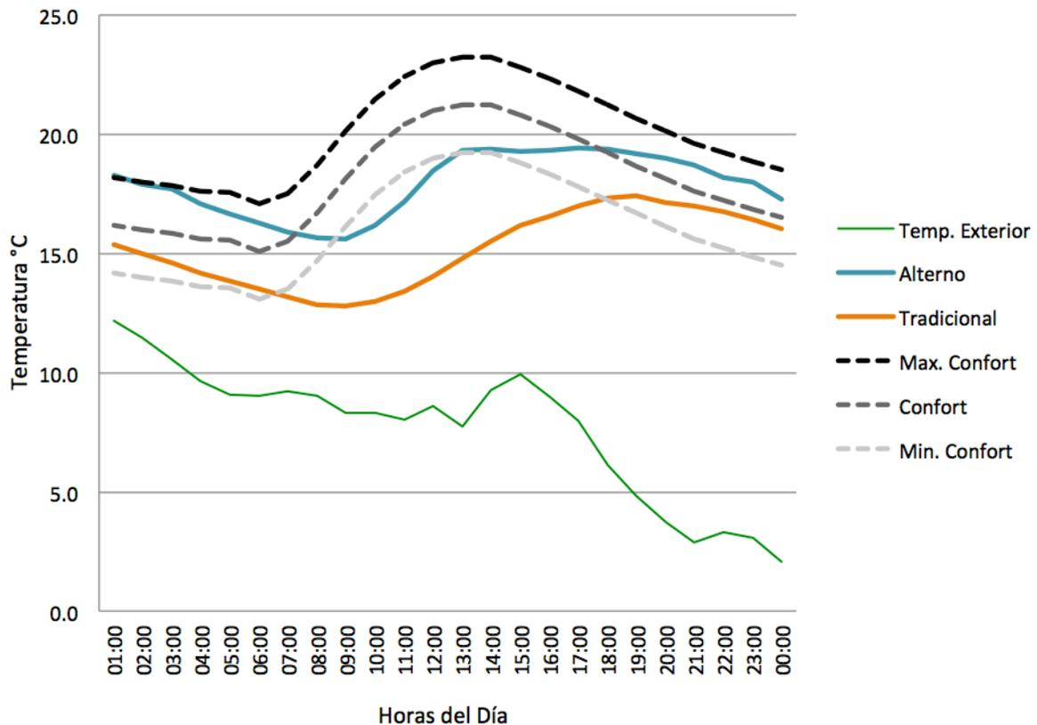
Gráfica 20: Comportamiento de las temperaturas del día 06 de enero resultado de la simulación del prototipo con sistema alterno y sistema tradicional.
