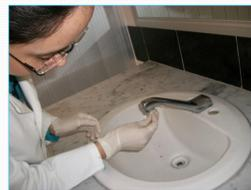
Figura 2: Desinfección de la toma de agua y muestreo.
