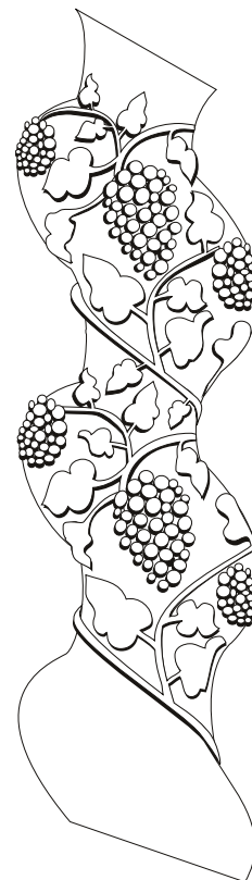
64. Corte de la columna salomónica y detalle de la talla escultórica, capilla de Loreto. Nótese la similitud en cuanto al recorrido del helicoide respecto a la columna diseñada por Ricci.
