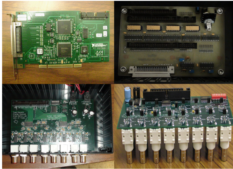
Figura 3-26: Las 4 tarjetas que forman el sistema de control de laboratorio. Parte superior izquierda, tarjeta NI PCI6533 de National Instruments . Parte superior derecha, buffer . Parte inferior izquierda, convertidor digital a analógico (DAC) y parte inferior derecha, tarjeta digital (DiO) .
