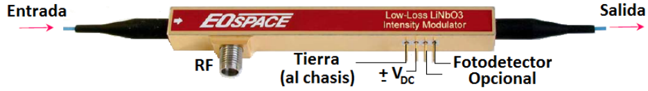
Figura 6-14: Imagen del EOM . Se muestran las dos entradas de control: La entrada de radiofrecuencia mediante un cable SMA y la de voltaje DC mediante dos pines. El fotodetector no lo tenemos en uso. La luz de entrada y de salida se acopla mediante fibra óptica. [84].
