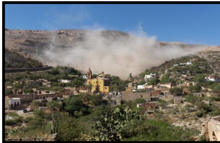
Figura 2.12. Levantamiento de partículas en voladura (Amador, 2007).
