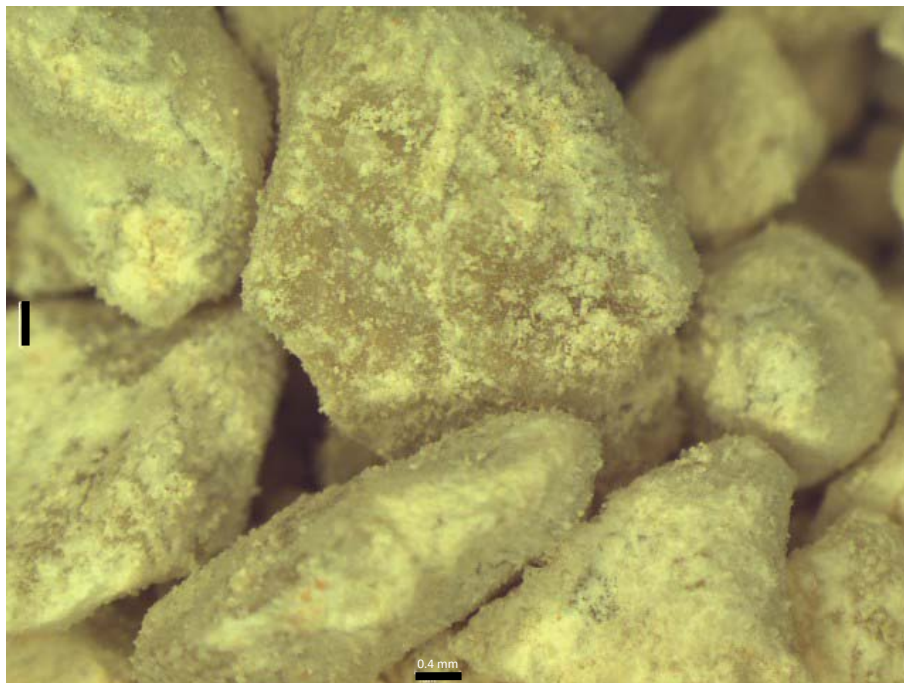
Fotografía 4: Muestra fragmentos de una roca tipo Wackstone. Pozo 6 a 4.5 m de profundidad (Obtenida a 0.8 X en un microscopio estereoscópico).
