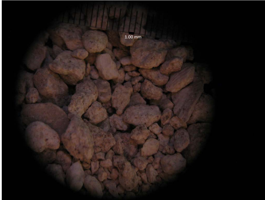
Fotografía 8: Muestra fragmentos de una roca tipo Packstone. Pozo 4 a 16.5 m de profundidad (Obtenida a 0.8 X en un microscopio estereoscópico).
