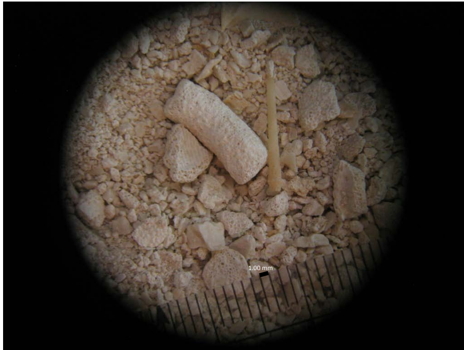
Fotografía 16: Muestra foraminíferos y corales en un Boundstone. Pozo 3 a 28.5 m de profundidad (Obtenida a 0.75 X en un microscopio estereoscópico).
