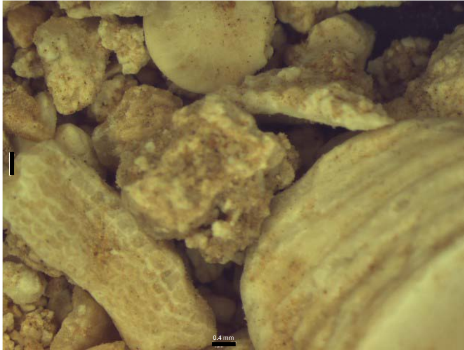
Fotografía 23: Muestra bioclastos de briozoos y foraminíferos. Pozo 5 a 37.5 m de profundidad (Obtenida a 0.8 X en un microscopio estereoscópico).
