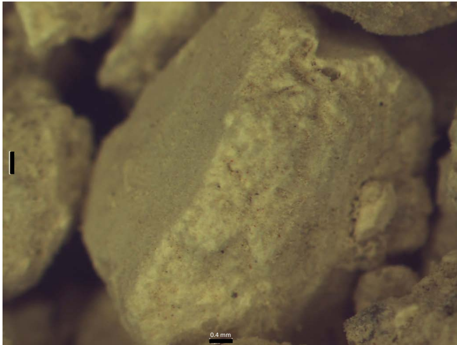
Fotografía 26: Muestra oolitos-peloides y porosidad intergranular. Pozo 4 a 49.5 m de profundidad (Obtenida a 0.8 X en un microscopio estereoscópico).
