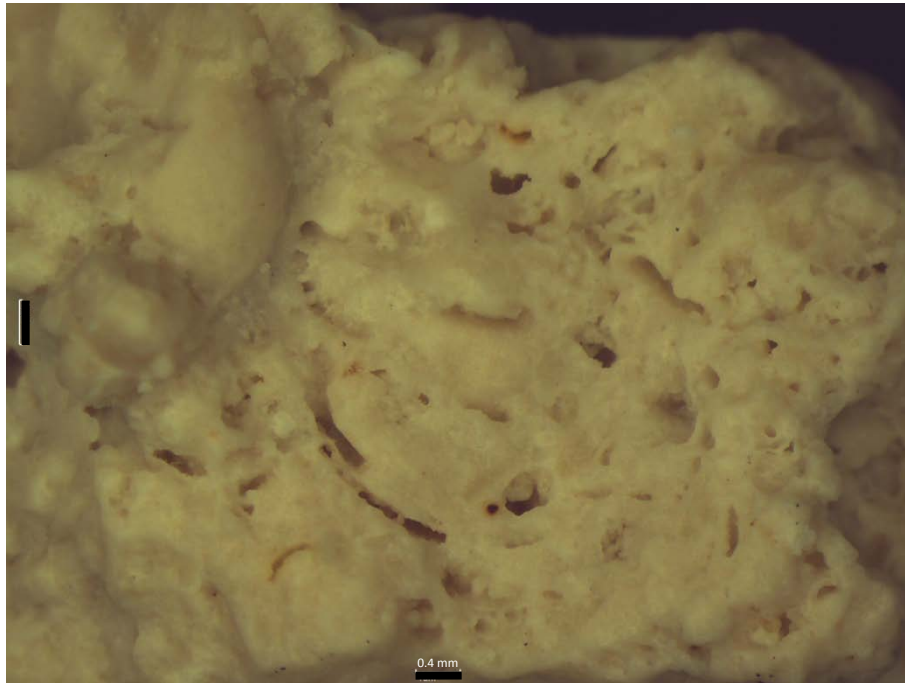
Fotografía 5: Muestra oolitos-peloides y porosidad móldica. Pozo 11 de 10-12 m de profundidad (Obtenida a 0.8 X en un microscopio estereoscópico).
