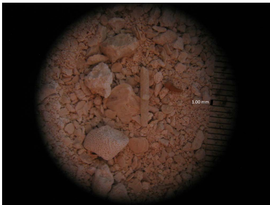
Fotografía 20: Muestra abundantes bioclastos en un Boundstone. Pozo 3 a 34.5 m de profundidad (Obtenida a 0.75 X en un microscopio estereoscópico).
