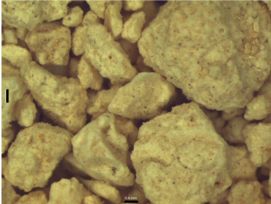
Fotografía 11: Muestra oolitos-peloides y porosidad intergranular. Pozo 4 a 25.5 m de profundidad (Obtenida a 0.8 X en un microscopio estereoscópico).
