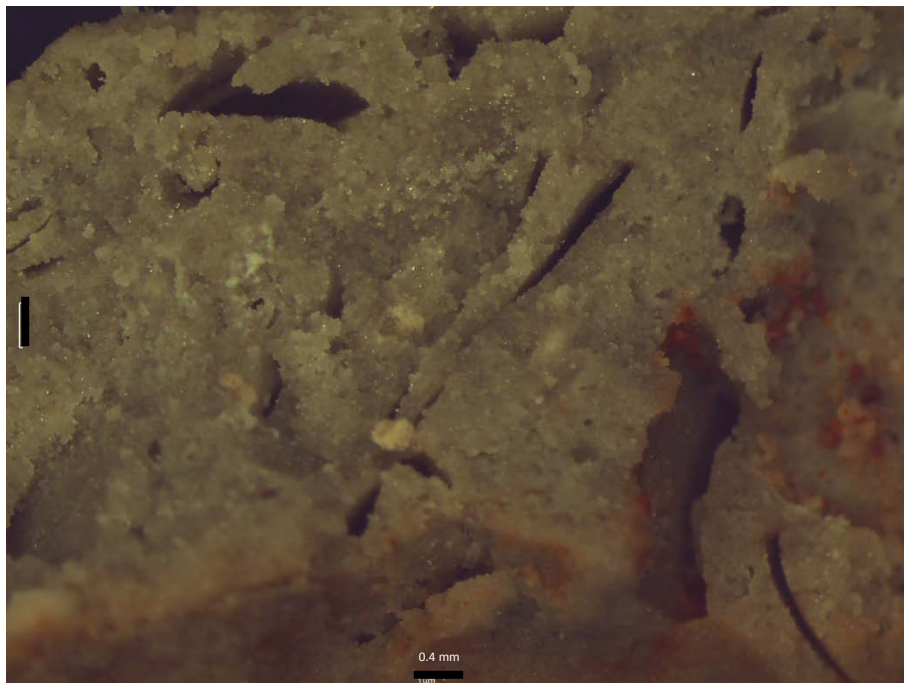
Fotografía 22: Muestra poros tipo móldicos de la disolución de moluscos. Pozo 17 a 31.5 m de profundidad (Obtenida a 0.8 X en un microscopio estereoscópico).
