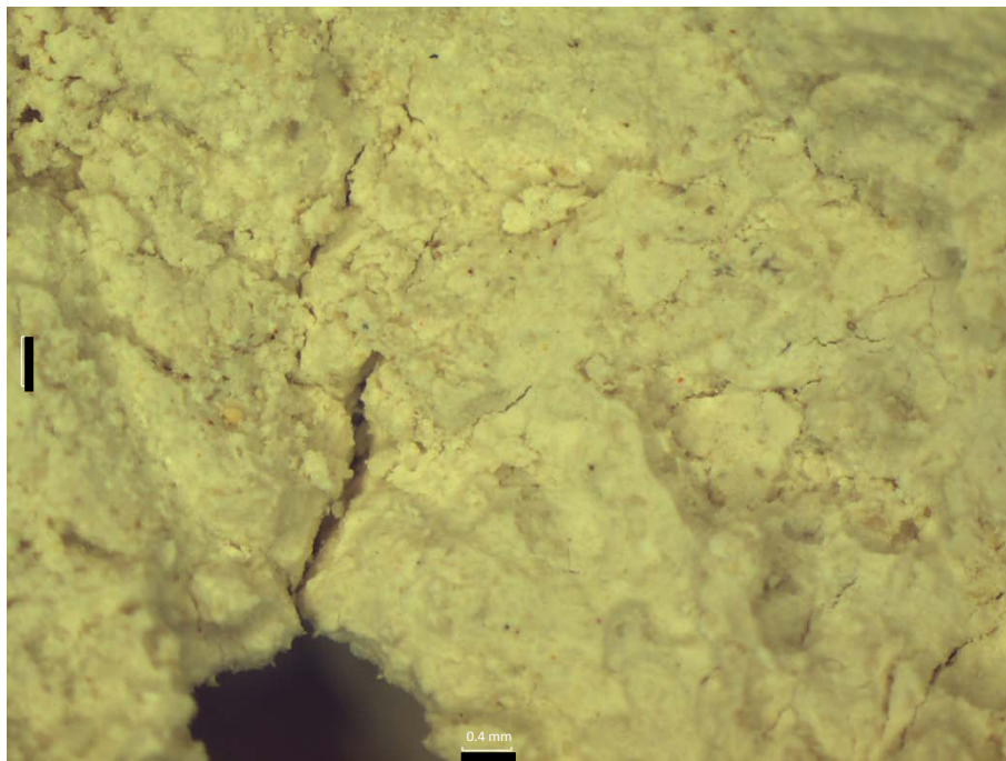
Fotografía 22: Muestra lodos y arcillas de un Wackstone. Pozo 19 a 31.5 m de profundidad (Obtenida a 0.8 X en un microscopio estereoscópico).
