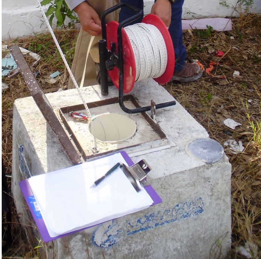
Figura 3.4: Medición del nivel estático del agua.
