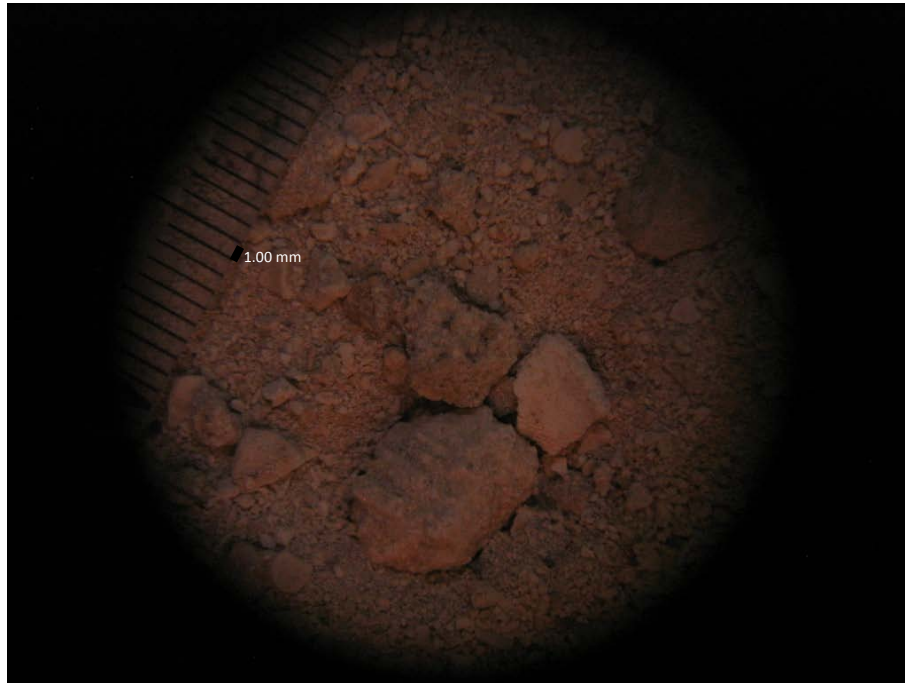
Fotografía 22: Muestra bioclastos muy fragmentados y oolitos-peloides?. Pozo 3 a 40.5 m de profundidad (Obtenida a 0.75 X en un microscopio estereoscópico).
