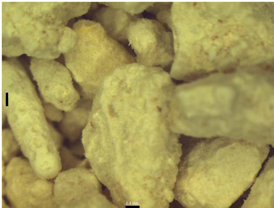
Fotografía 15: Muestra fragmentos de una roca tipo Packstone. Pozo 6 a 22.5 m de profundidad (Obtenida a 0.8 X en un microscopio estereoscópico).
