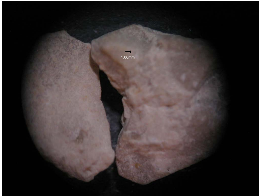
Fotografía 4: Muestra oolitos-peloides en un roca tipo Wackstone. Pozo 3 a 7.5 m de profundidad (Obtenida a 0.75 X en un microscopio estereoscópico).
