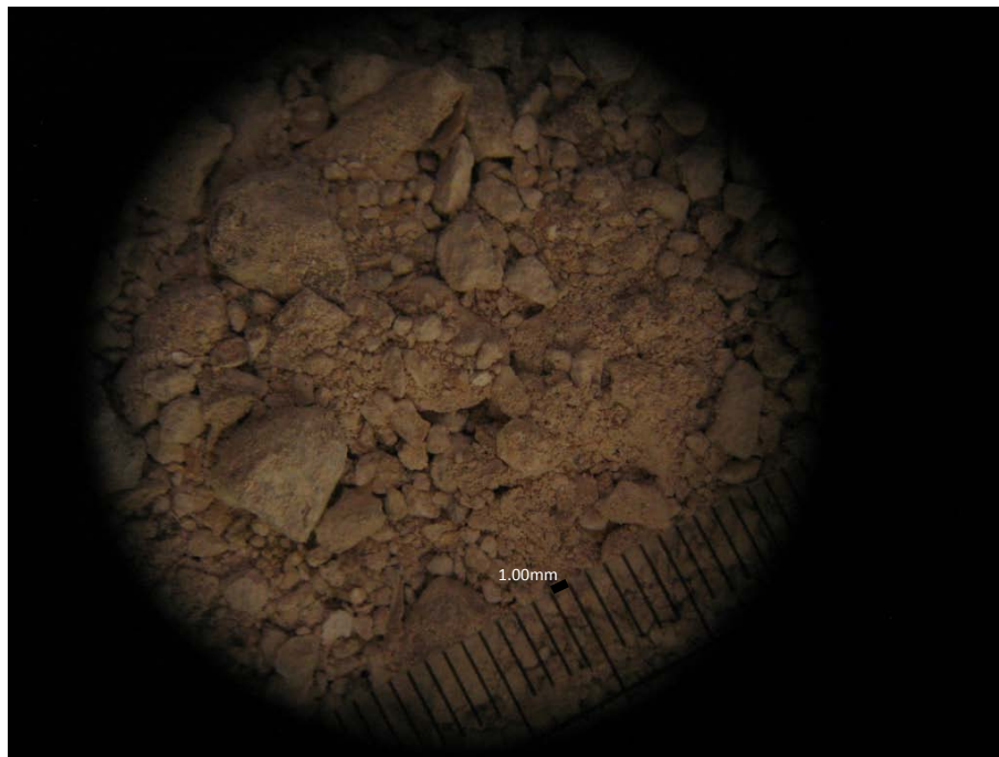
Fotografía 2: Muestra oolitos-peloides y porosidad intergranular. Pozo 4 a 1.5 m de profundidad (Obtenida a 0.8 X en un microscopio estereoscópico).
