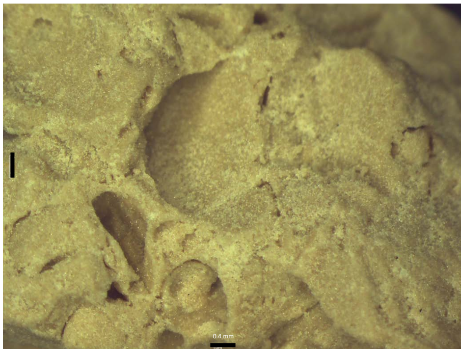
Fotografía 36: Muestra oolitos-peloides y porosidad intergranular y móldica. Pozo 14 a 52.5 m de profundidad (Obtenida a 0.8 X en un microscopio estereoscópico).
