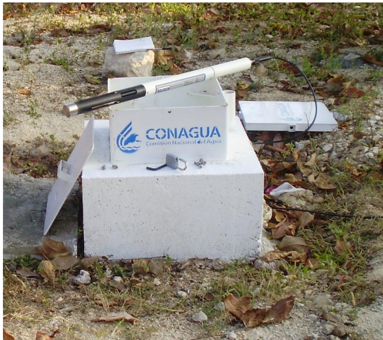
Figura 3.5: Sonda multiparamétrica con la cual se realizaron los monitoreos de la calidad del agua.
