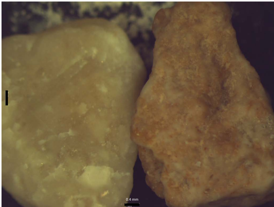
Fotografía 4: Muestra oolitos-peloides en una Packstone. Pozo 13 a 4.5 m de profundidad (Obtenida a 0.8 X en un microscopio estereoscópico).
