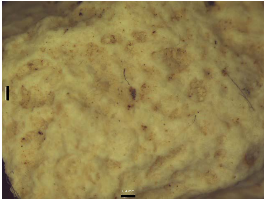
Fotografía 27: Muestra oolitos-peloides y porosidad intergranular. Pozo 7 a 40.5 m de profundidad (Obtenida a 0.8 X en un microscopio estereoscópico).
