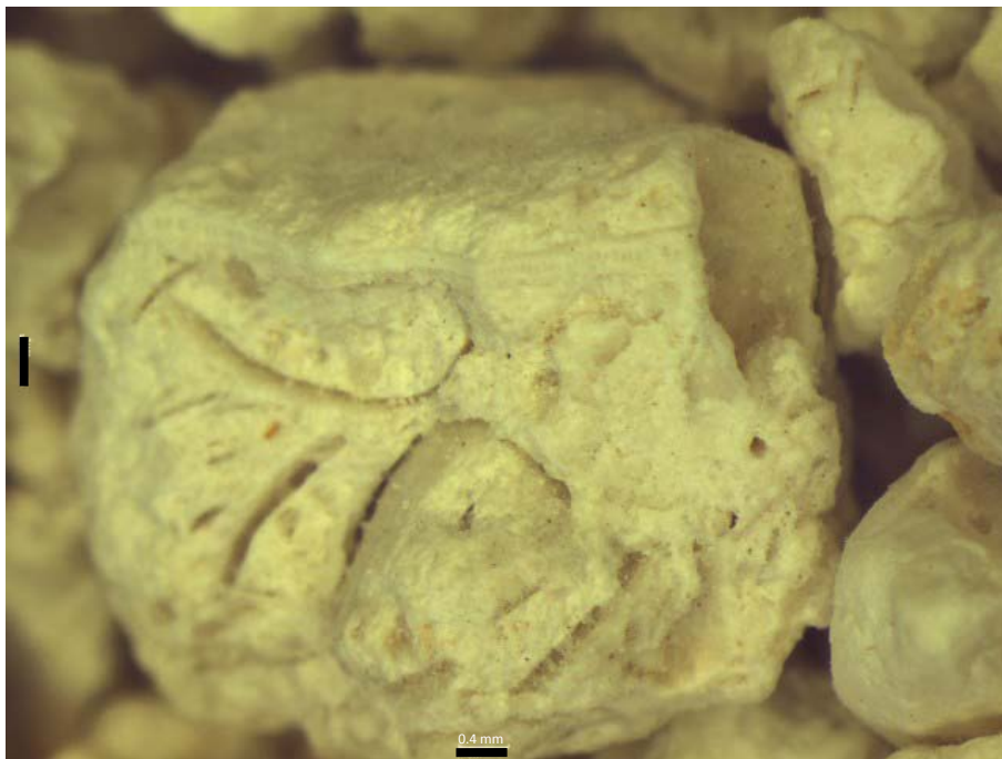
Fotografía 27: Muestra oolitos-peloides y porosidad móldica. Pozo 6 a 40.5 m de profundidad (Obtenida a 0.8 X en un microscopio estereoscópico).
