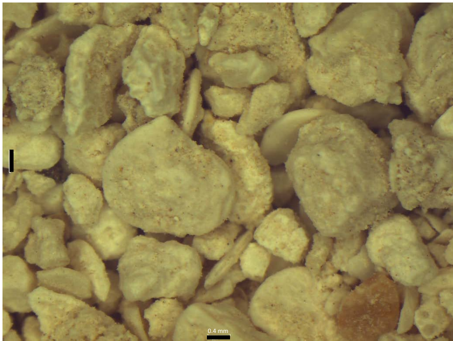
Fotografía 18: Muestra corales y foraminíferos de un Boundstone. Pozo 2 a 25.5 m de profundidad (Obtenida a 0.8 X en un microscopio estereoscópico).
