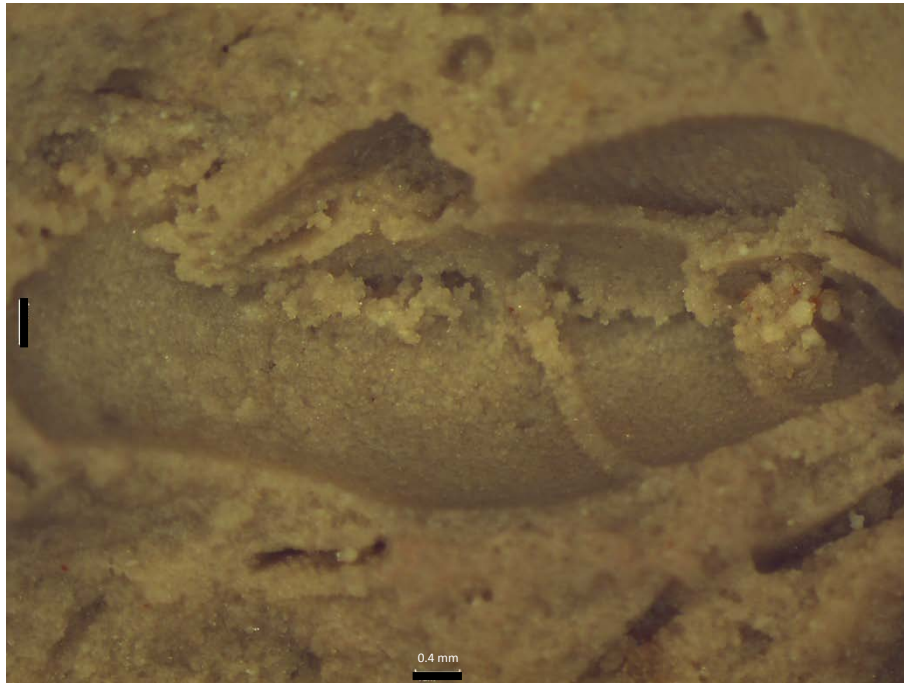
Fotografía 25: Muestra poros tipo móldico y oolitos-peloides. Pozo 17 a 37.5 m de profundidad (Obtenida a 0.8 X en un microscopio estereoscópico).
