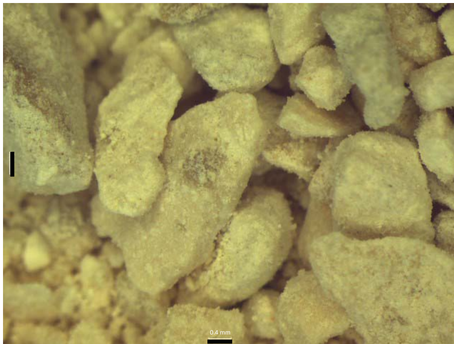
Fotografía 4: Muestra fragmentos de una roca tipo Wackstone. Pozo 7 a 4.5 m de profundidad (Obtenida a 0.8 X en un microscopio estereoscópico).
