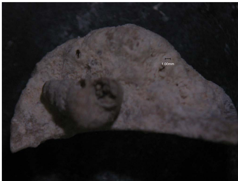
Fotografía 1: Muestra oolitos-peloides y porosidad intergranular. Pozo 3 a 1.5 m de profundidad (Obtenida a 0.75 X en un microscopio estereoscópico).
