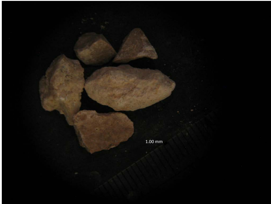
Fotografía 3: Muestra oolitos-peloides soportados en cementante. Pozo 4 a 4.5 m de profundidad (Obtenida a 0.8 X en un microscopio estereoscópico).
