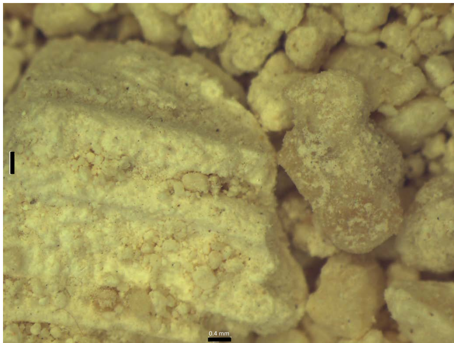
Fotografía 8: Muestra molde de bioclasto y fragmentos de un Packstone. Pozo 9 a 10 m de profundidad (Obtenida a 0.8 X en un microscopio estereoscópico).
