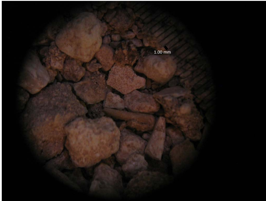
Fotografía 9: Muestra fragmentos de bioclastos y roca tipo Packstone. Pozo 4 a 19.5 m de profundidad (Obtenida a 0.8 X en un microscopio estereoscópico).
