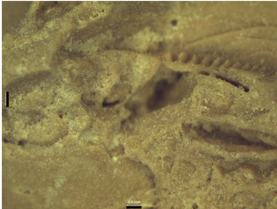
Fotografía 35: Muestra molde de bioclasto y porosidad móldica. Pozo 14 a 52.5 m de profundidad (Obtenida a 0.8 X en un microscopio estereoscópico).
