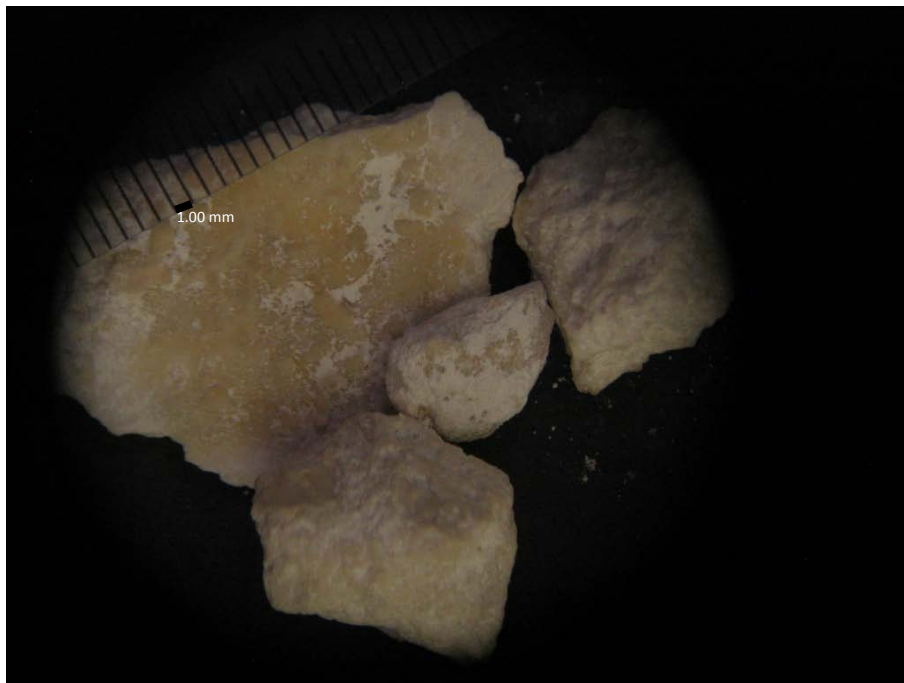
Fotografía 6: Muestra oolitos-peloides en una roca tipo Packstone. Pozo 4 a 10.5 m de profundidad (Obtenida a 0.8 X en un microscopio estereoscópico).
