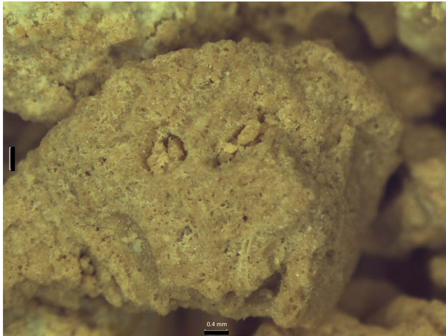
Fotografía 33: Muestra oolitos-peloides y porosidad móldica en Grainstone. Pozo 19 a 49.5 m de profundidad (Obtenida a 0.8 X en un microscopio estereoscópico).
