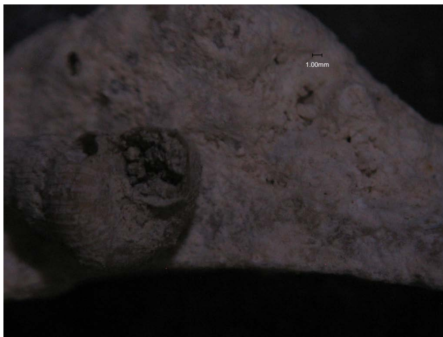
Fotografía 2: Muestra oolitos-peloides y porosidad intergranular. Pozo 3 a 1.5 m de profundidad (Obtenida a 0.75 X en un microscopio estereoscópico).
