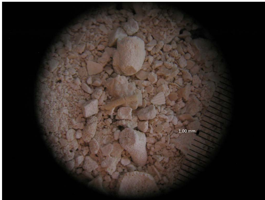
Fotografía 17: Muestra corales, briozoos y foraminíferos en un Boundstone. Pozo 3 a 31.5 m de profundidad (Obtenida a 0.75 X en un microscopio estereoscópico).
