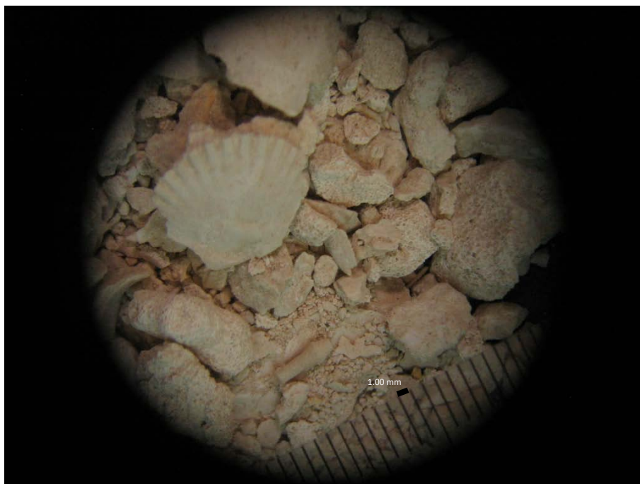
Fotografía 13: Muestra corales de una roca tipo Boundstone. Pozo 3 a 22.5 m de profundidad (Obtenida a 0.75 X en un microscopio estereoscópico).
