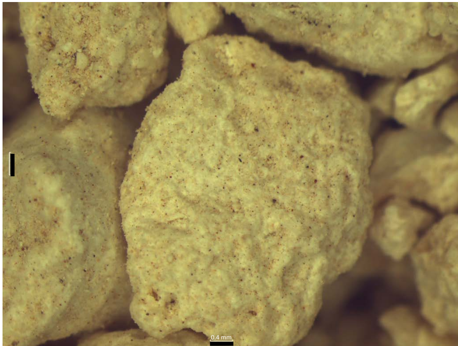
Fotografía 13: Muestra oolitos-peloides y porosidad intergranular. Pozo 4 a 28.5 m de profundidad (Obtenida a 0.8 X en un microscopio estereoscópico).
