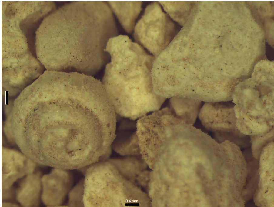
Fotografía 20: Muestra moldes de gasterópodos de una roca tipo Grainstone. Pozo 4 a 40.5 m de profundidad (Obtenida a 0.8 X en un microscopio)
