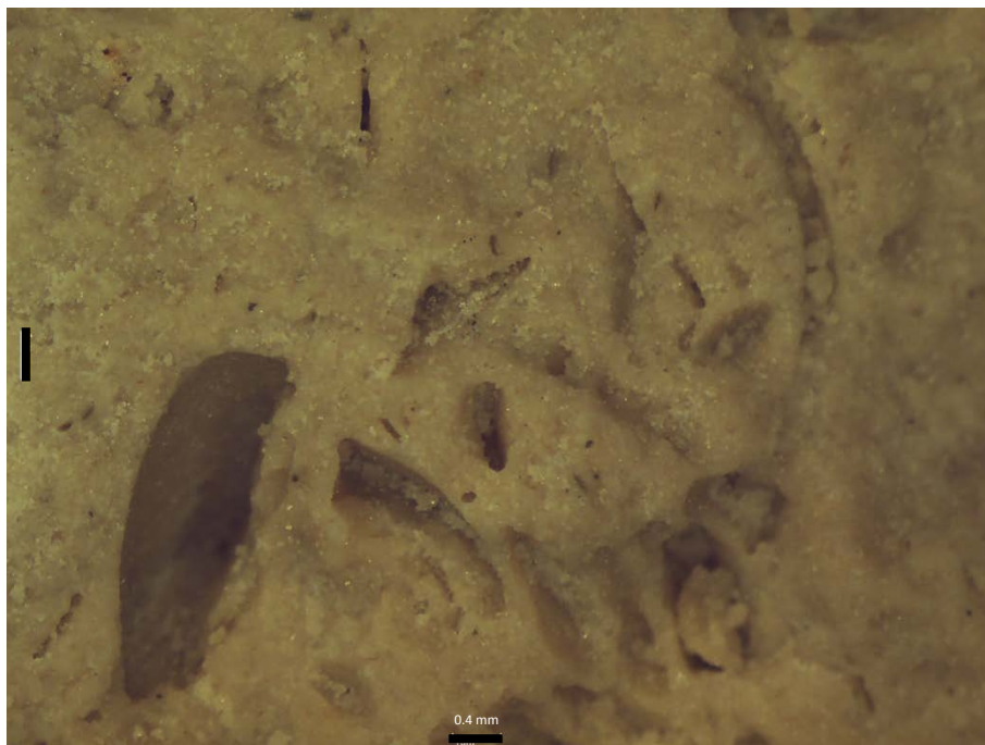
Fotografía 32: Muestra oolitos-peloides y porosidad intergranular y móldica. Pozo 14 a 46.5 m de profundidad (Obtenida a 0.8 X en un microscopio estereoscópico).
