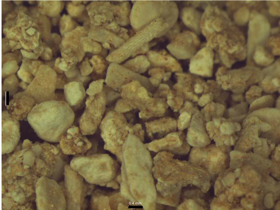
Fotografía 21: Muestra oolitos-peloides y fragmentos de foraminíferos. Pozo 5 a 34.5 m de profundidad (Obtenida a 0.8 X en un microscopio estereoscópico).
