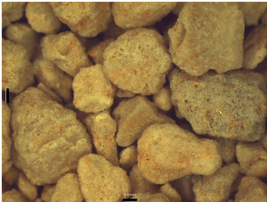
Fotografía 28: Muestra fragmentos porosos de un Packstone. Pozo 17 a 40.5 m de profundidad (Obtenida a 0.8 X en un microscopio estereoscópico).
