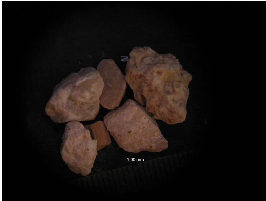
Fotografía 7: Muestra oolitos-peloides y porosidad intergranular. Pozo 4 a 13.5 m de profundidad (Obtenida a 0.8 X en un microscopio estereoscópico).
