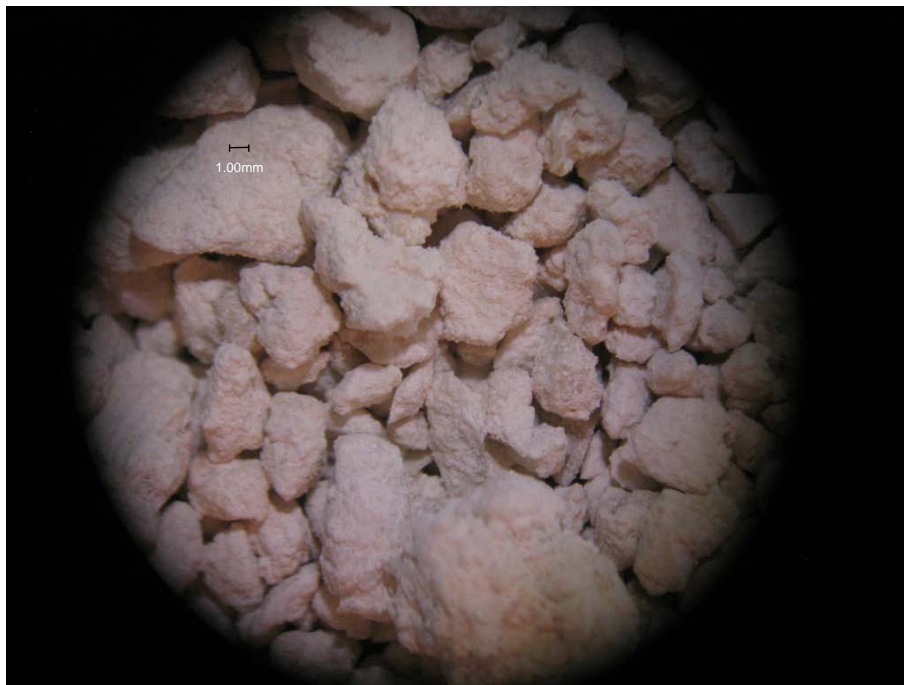
Fotografía 6: Muestra oolitos-peloides y porosidad intergranular. Pozo 3 a 10.5 m de profundidad (Obtenida a 0.75 X en un microscopio estereoscópico).
