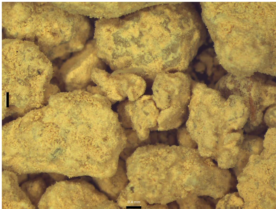
Fotografía 1: Muestra fragmentos del litosol cálcico. Pozo 13 a 1.5 m de profundidad (Obtenida a 0.8 X en un microscopio estereoscópico).
