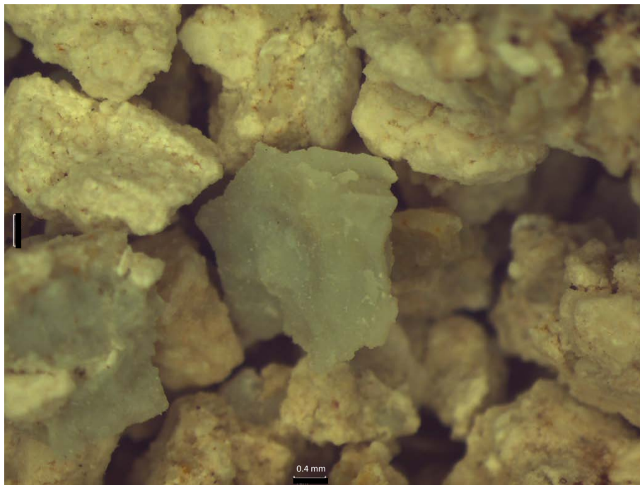
Fotografía 24: Muestra lodos calcáreo color verde en un Wackstone. Pozo 19 a 34.5 m de profundidad (Obtenida a 0.8 X en un microscopio estereoscópico).
