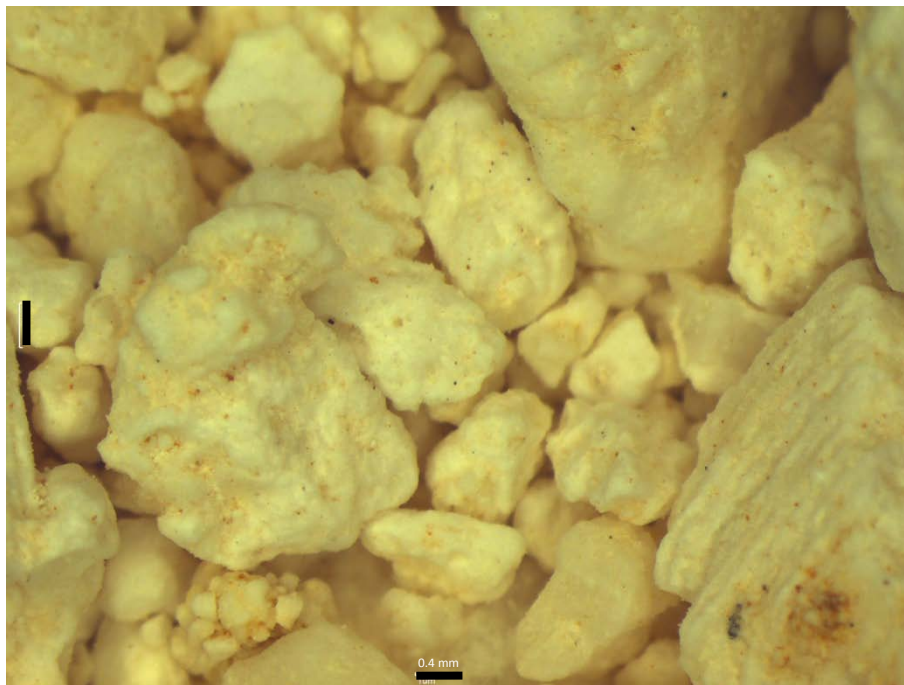
Fotografía 26: Muestra oolitos-peloides y porosidad intergranular. Pozo 11 de 53-59 m de profundidad (Obtenida a 0.8 X en un microscopio estereoscópico).
