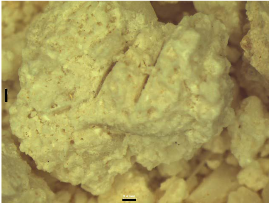
Fotografía 9: Muestra oolitos-peloides y porosidad intergranular. Pozo 6 a 13.5 m de profundidad (Obtenida a 0.8 X en un microscopio estereoscópico).
