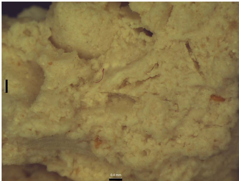
Fotografía 24: Muestra oolitos-peloides y porosidad intergranular. Pozo 16 a 34.5 m de profundidad (Obtenida a 0.8 X en un microscopio estereoscópico).
