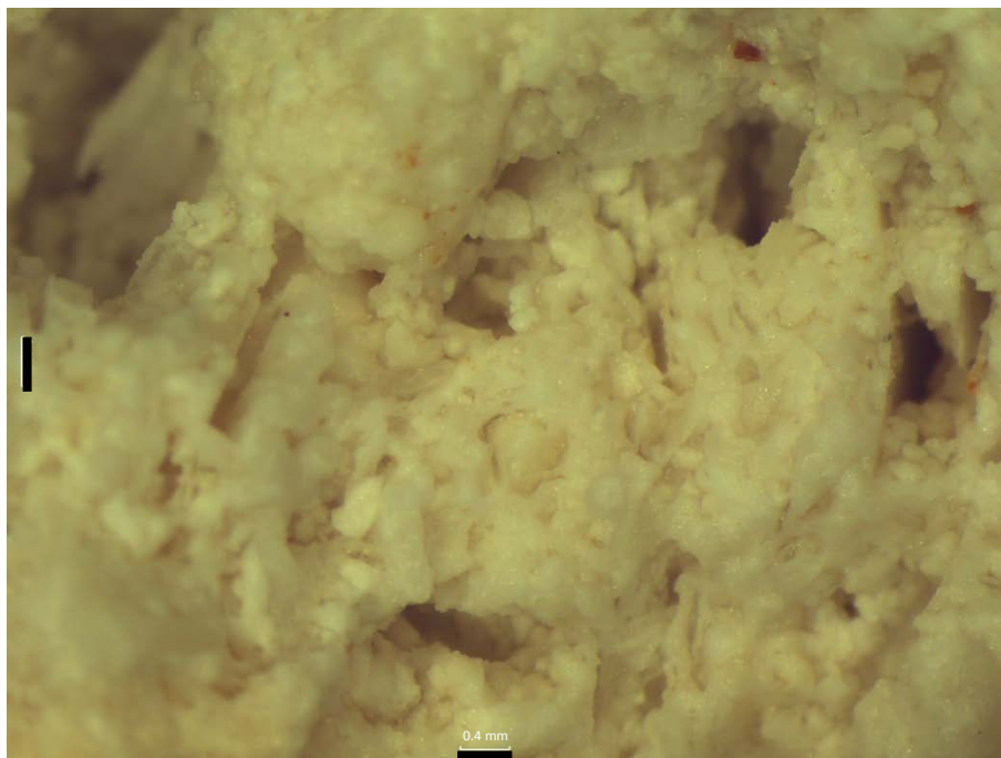
Fotografía 14: Muestra oolitos-peloides y porosidad intergranular. Pozo 14 a 19.5 m de profundidad (Obtenida a 0.8 X en un microscopio estereoscópico).
