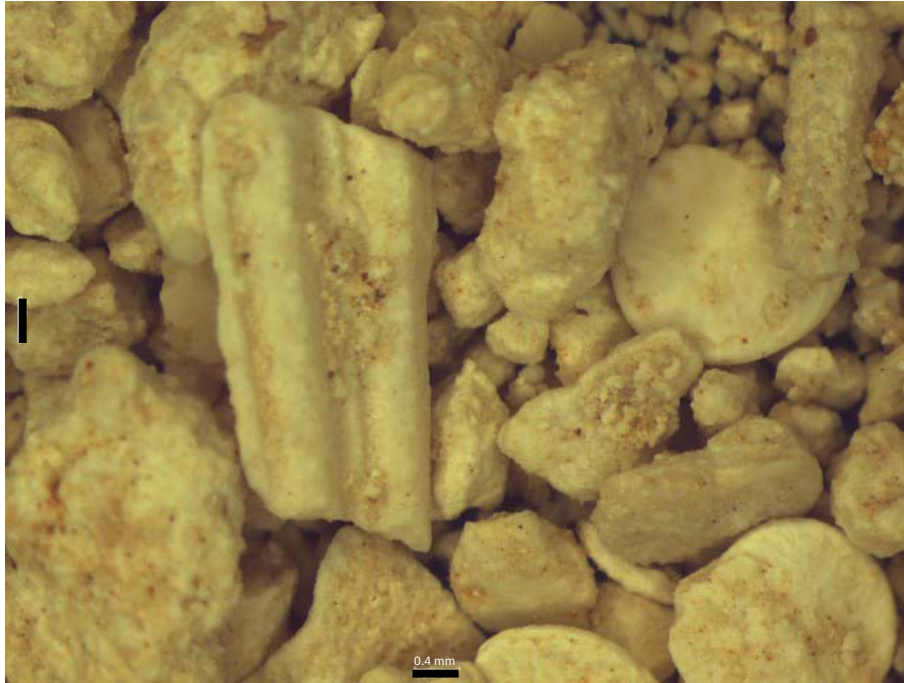
Fotografía 19: Muestra fragmentos de bivalvos y foraminíferos bentónicos. Pozo 5 a 31.5 m de profundidad (Obtenida a 0.8 X en un microscopio estereoscópico).
