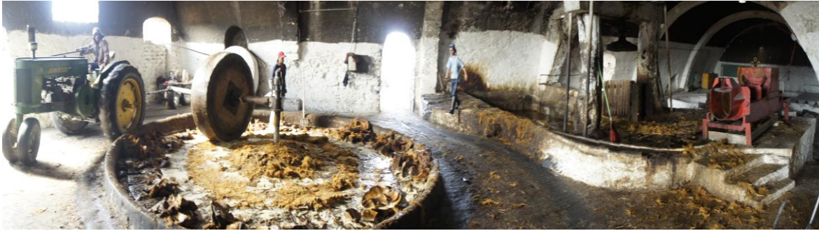
Fig. 2.9. Molino, pileta de enjuague y prensa manual de tornillo para bagazo lavado. Fábrica “Laguna Seca”.
