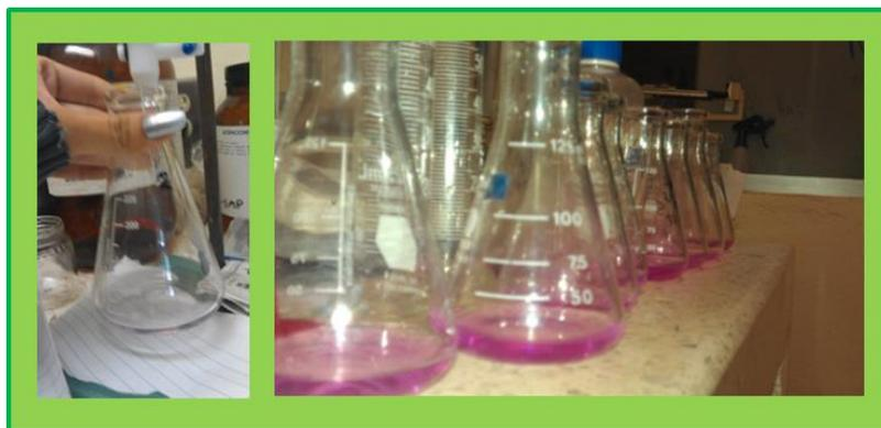
**Figura 5.** Alícuota de una de las repeticiones de las muestras al momento de ser titulada y alícuotas ya tituladas con la coloración característica de la interacción del hidróxido de sodio con el indicador fenolftaleína.
