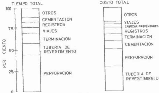
Fig.4 TIEMPO DE PERFORACION Y COSTO DE OPERACION POZO MODELO EAST MESA
