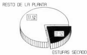
Figura 4. Distribución del consumo de vapor en la planta de Química Hoechst de Santa Clara.
