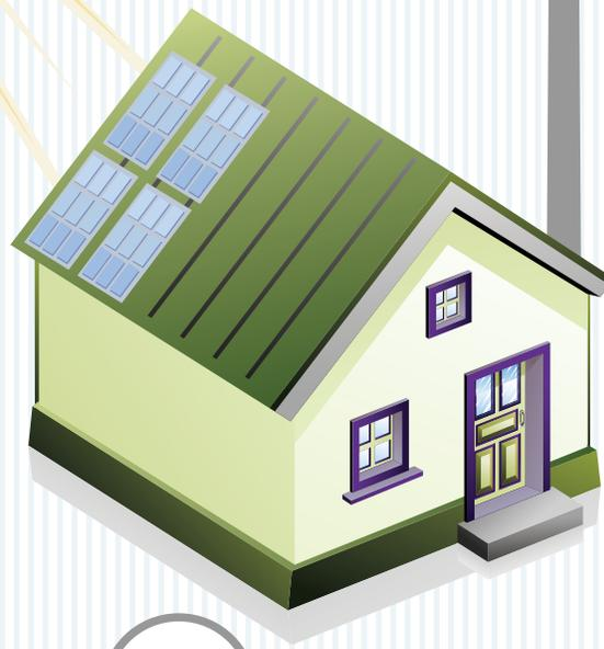
En un esquema de autogeneración de energía eléctrica, una vivienda unifamiliar produce durante las horas de sol una cierta cantidad de energía por medio de un arreglo de paneles solares. Dicho arreglo está conectado a la red eléctrica pública, y permite el flujo bidireccional de electricidad entre la red y la vivienda.
